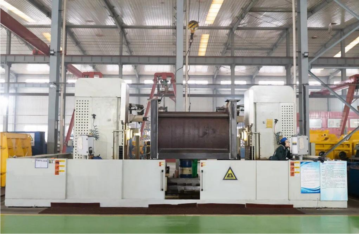
**Çift Başlı Delik Delme Makinesi; ana mil hizalama amaçlı / Double Head Boring Machine; for main Shaft Alignment
